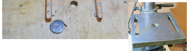
Beim 2. Versuch war eine Frästiefe falsch eingestellt und der Durchmesser für die Magnete zu groß.
