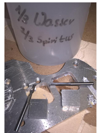
Versuch mit 1/8" Spiral- und geradem Nutfräser
