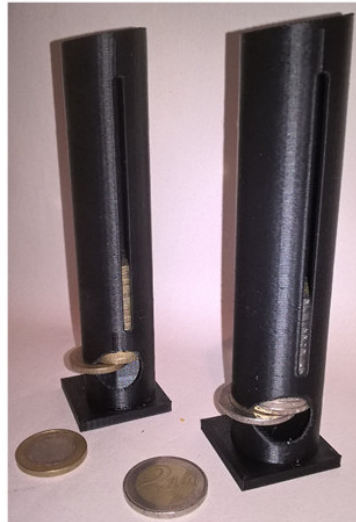
Münzturm 1€ und 2€, Entnahmeschlitz mit Metallabgeblätt nachträglich erstellt. -Lp
