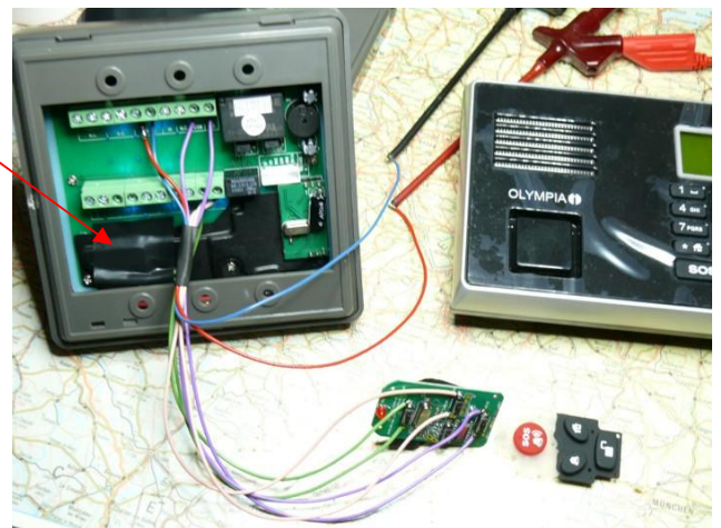
Direkter Anschluss Codeschloss an Olympia Fernbedienung
